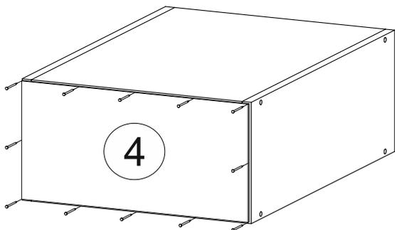
**Рис.4. Установка антресоли на пенал**
